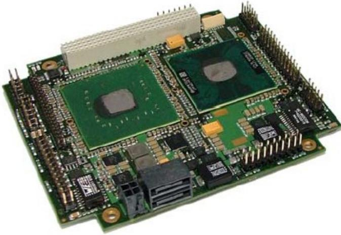
**Классический формат одноплатного компьютера PC/104** имеет массу модификаций, которые отличаются наличием различных шин расширения. Модули стыкуются друг к другу вертикально, образуя многослойную конструкцию из одноплатного компьютера и периферийных модулей или т.н. “стек PC/104”.
